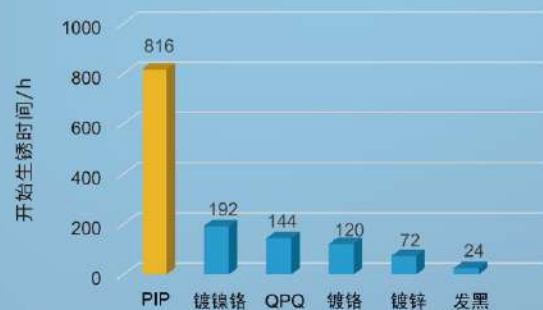
图2 中性盐雾实验抗腐蚀性对比
